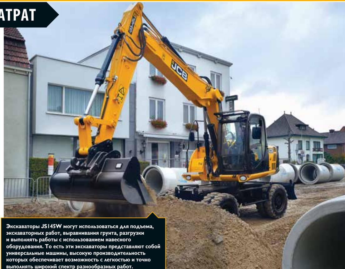
Экскаваторы JS145W могут использоваться для подъема, экскаваторных работ, выравнивания грунта, разгрузки и выполнения работ с использованием навесного оборудования. То есть эти экскаваторы представляют собой универсальные машины, высокую производительность которых обеспечивает возможность с легкостью и точно выполнять широкий спектр разнообразных работ.
